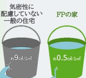
住宅の気密性とは、バケツから水が漏れるのと同様に、家からどれだけ空気が漏れるかを表す性能のこと。つまり、住宅にあいた隙間がどれくらいあるかを数値で表したものが気密性で、これは「相当隙間面積(C値)」を実測することで比較できる。
